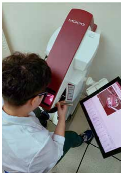
學生在Simodont上練習牙冠修形，老師可同步在螢幕上看到過程！
